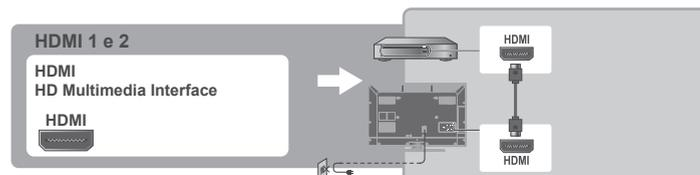
Utilize a entrada HDMI para conectar o DVD, Blu-Ray, Box de TV a cabo, Video Game ou qualquer outro aparelho que disponibilize essa conexão. Utilizando essa conexão, a imagem ficará melhor, pois é uma conexão digital.
