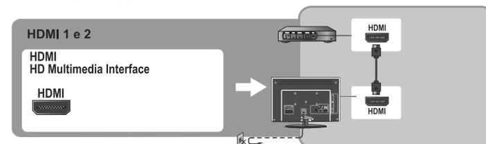
Utilize a entrada HDMI para conectar o DVD, Blu-Ray, Box de TV a cabo, Vídeo Game ou qualquer outro aparelho que disponibilize essa conexão. Utilizando essa conexão, a imagem ficará melhor, pois é uma conexão digital.
