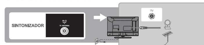
Conecte o cabo de sua antena ou o cabo da TV a Cabo na entrada da TV "Antena/Cable". Pela sua antena, você sintonizará os canais digitais e analógicos. Se utilizar o cabo da TV a Cabo, você sintonizará os canais da operadora de canais.
