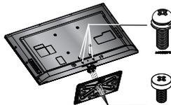
5. Utilize uma chave adequada para apertar os parafusos e prender o pedestal e a base à TV.
