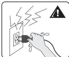
Não toque no cabo de alimentação CA com a mão úmida, pois isso poderá causar choque elétrico.
