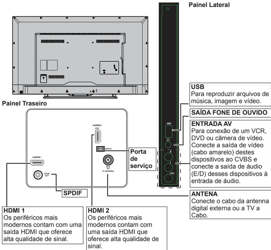
**NOTAS:** Uma vez que seu equipamento estiver corretamente conectado na TV, utilize o botão INPUT do controle remoto para selecionar a entrada adequada. Sempre desligue a TV da tomada para conectar os equipamentos nas conexões periféricas.
