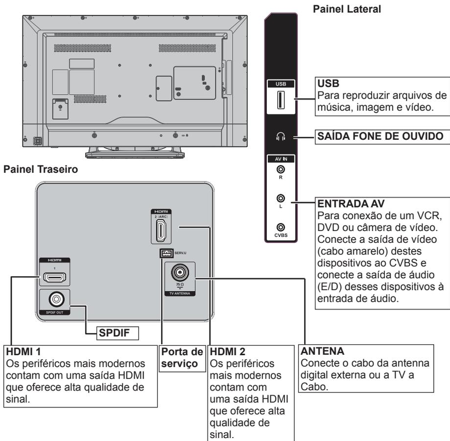
**NOTAS:** Uma vez que seu equipamento estiver corretamente conectado na TV, utilize o botão INPUT do controle remoto para selecionar a entrada adequada. Sempre desligue a TV da tomada para conectar os equipamentos nas conexões periféricas.
