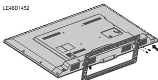
3. Apertar 4 parafusos para a montagem da base.
