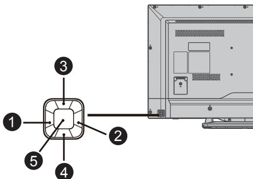
Para acessar o Menu da TV sem utilizar o controle remoto, pressione o Joystick na parte inferior da TV, conforme imagem acima. A TV apresentará o menu com quatro opções: Ligar/Desligar, Volume, Canais e Fonte de Entrada. Utilize o cursor para navegar entre as opções.
