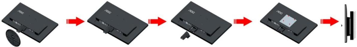
Este monitor pode ser montado num braço de fixação para parede, adquirido separadamente. Desconecte o cabo de alimentação antes deste procedimento. Siga os passos abaixo:
